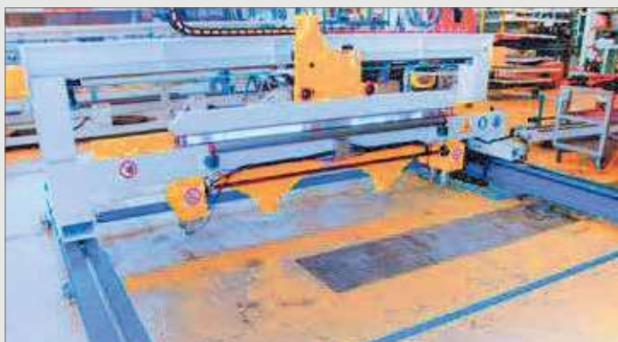
Modul-CONT gruppo di taglio longitudinale e trasversale / Modul-CONT rip cut and cross cut unit
