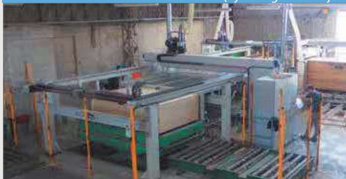
Sezionatrice-rifilatrice per pannelli di compensato e derivati (H 80 mm) Saw blade and trim cut machine for plywood panel (H 80 mm)
