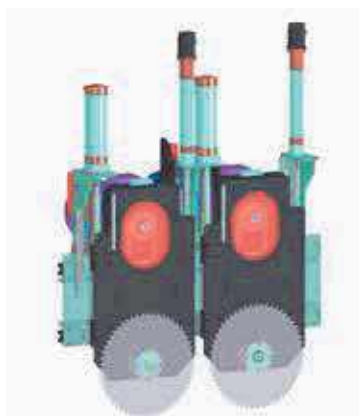
Troncatrice trasversale per barre Modul-HS (con taglio avanti/indietro) / Modul-HS Cutting machine
