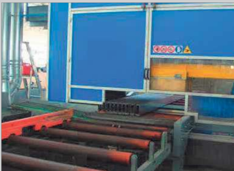
Gruppo di taglio per estrusi di alluminio (H 100 - 430 mm) Cutting group for aluminum extruded (up to 100 and up to 430 mm thickness)
